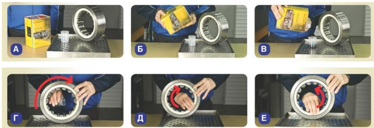
Рис. 1 - Порядок обработки деталей блока подшипника препаратом-модификатором ЭМПи-1.
