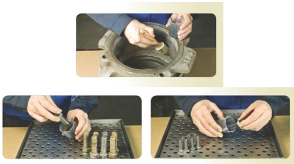
Рис. 3 Порядок обработки деталей буксового узла препаратом-модификатором эМПи-1.
